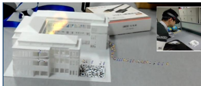
图 10：基于三维打印沙盘的 AR 人群疏散模拟可视化
